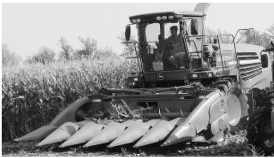
(写真2)スナップヘッド（アタッチメントを交換したらコーンサイレージと同じ機械で収穫できる）
